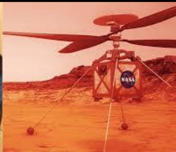
Los helicópteros en la Tierra generalmente giran a 400 a 500 rpm, las cuchillas del Ingenuity girarán a entre 2800 y 3000 rpm
