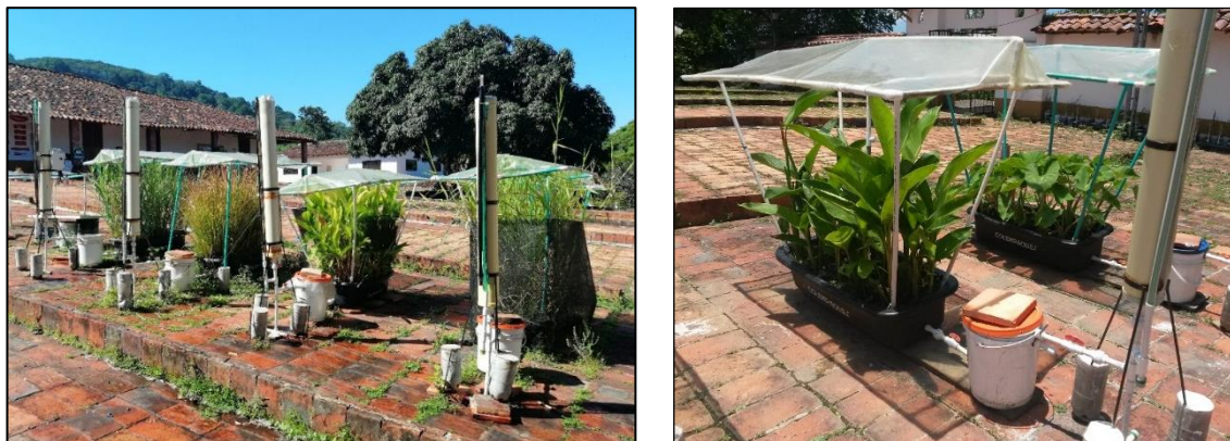
Figura 3. Humedales construidos con cero descarga y cubierta a escala piloto.
